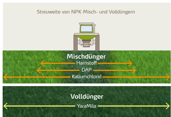
Abbildung 7: Volldünger ermöglichen ein gleichmäßiges Streuen über größere Arbeitsbreiten als Mischdünger, da die Streuweite von leichten Partikeln, wie etwa Harnstoff, geringer ist als die von schwereren, wie etwa DAP und Kaliumchlorid [1].
